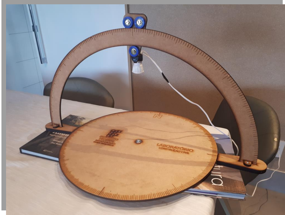
Figura 02 – Simulador de Trajetória Solar construído em MDF.
